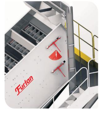
O equipamento possui uma Placa de indicação de inclinação de trabalho. A inclinação é ajustável em função das granulometrias e tipo do material a ser processado.
