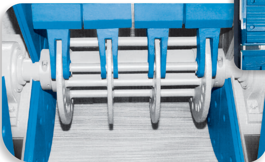
Detalhe da ampla câmara de moagem, dos revestimentos laterais e parachoques.
