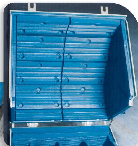
Detalhe da ampla câmara de moagem, dos revestimentos laterais e parachoques.
