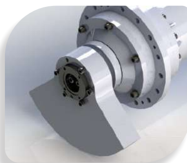
Detalhe do contrapeso tipo “leque”
