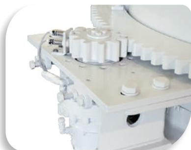
Sistema de ajuste de abertura (motor hidráulico).
