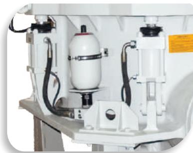
Sistema hidráulico de alívio de carga.
