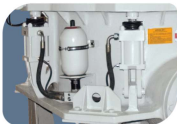
Sistema hidráulico de alívio de carga.
