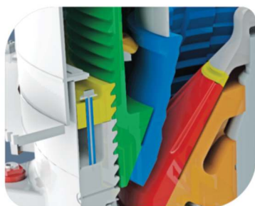
Detalhe da câmara de britagem (em corte).
