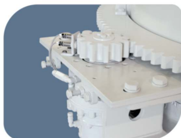
Sistema de ajuste de abertura (motor hidráulico).
