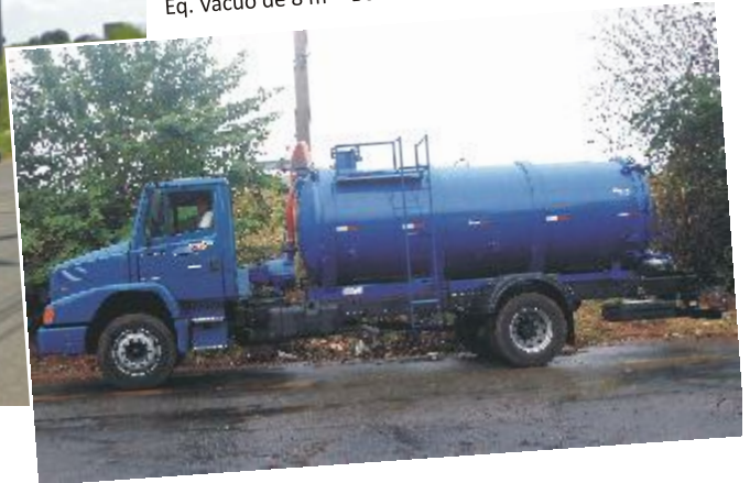
Eq. Vácuo de 8 m 3 - Bomba de Anel Líq. Mod. BAL 16.500
