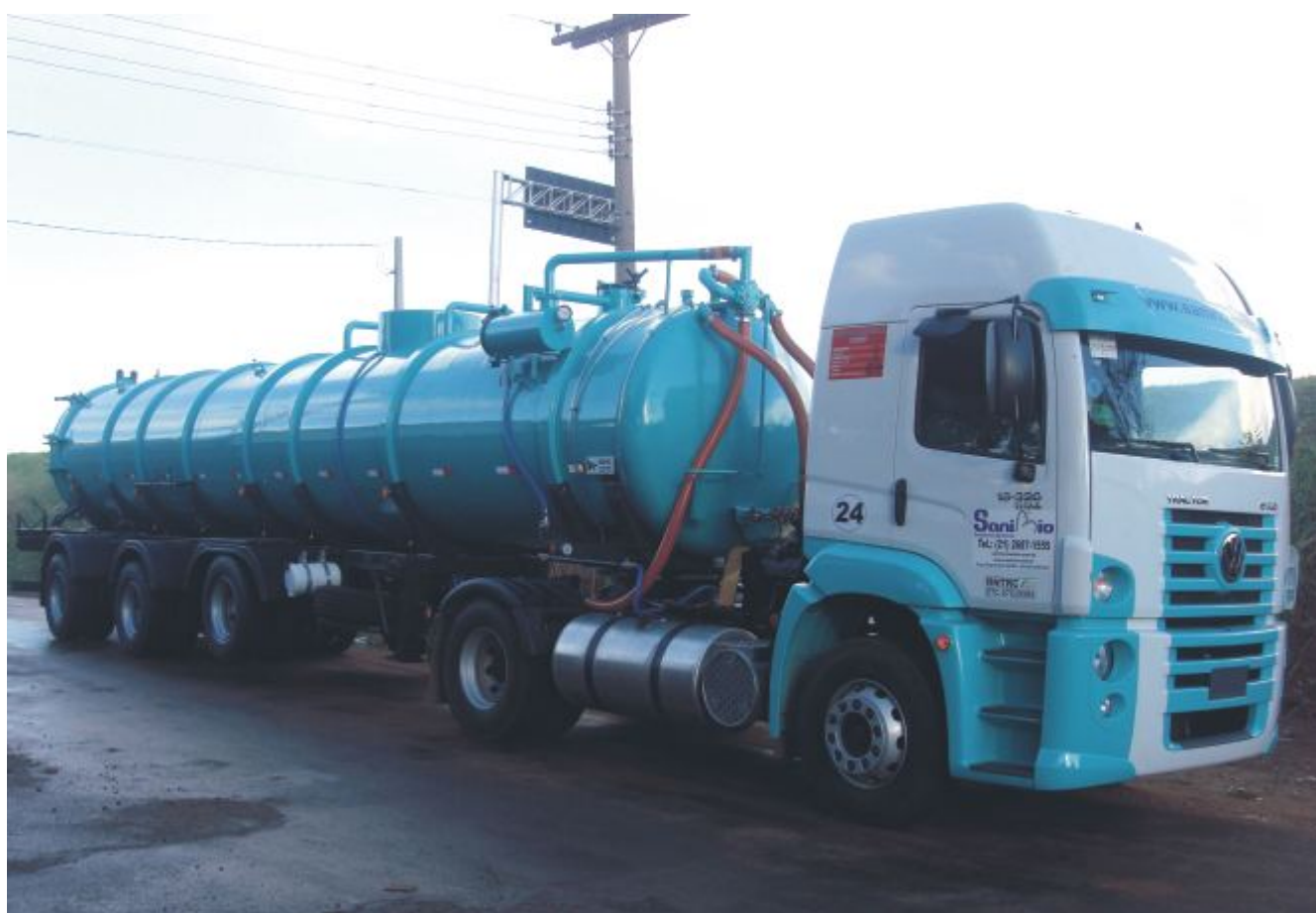
Semi-Reboque Tanque de 30.000 litros, com Bomba de Vácuo de Anel Líquido BAL 35.500, instalada na plataforma do cavalo mecânico
