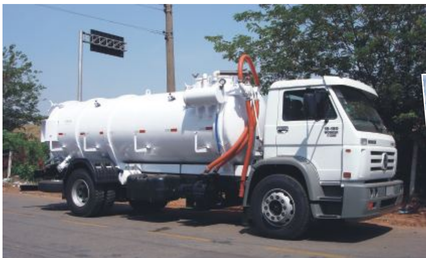
Equipamento Vácuo de 10 m 3 - Bomba de Anel Líquido Mod. BAL 24.500
