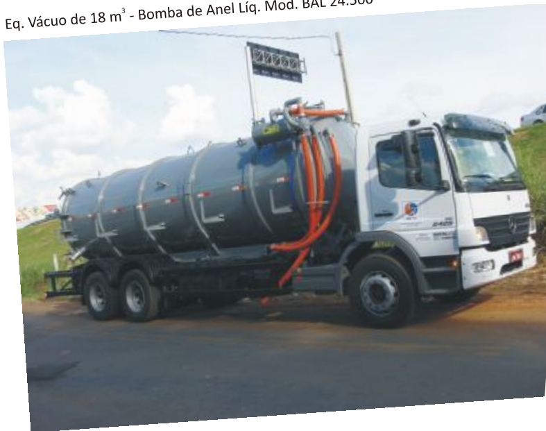
Equipamento Vácuo de 10 m 3 - Bomba de Anel Líquido Mod. BAL 24.500
