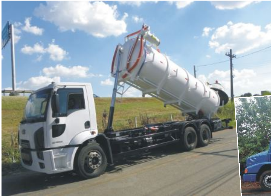
Equipamento Vácuo de 16 m 3 - Bomba de Anel Líq. Mod. BAL 24.500 Basculável
