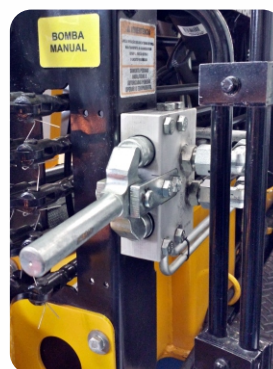
BOMBA DE EMERGENCIA
