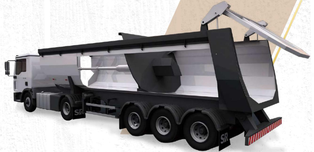
La utilización de este tipo de carrocería tiene el propósito de aumentar la precisión del proceso de descarga incluso en situaciones adversas como: descarga en terrenos inclinados; obras dentro de túneles; bajo los puentes y las redes eléctricas; calles arboladas; o en puertos donde la presencia de ráfagas de viento es constante. Con el propósito de superar estas adversidades, desarrollamos el sistema de descarga horizontal, construido con la dureza y calidad HARDOX.
