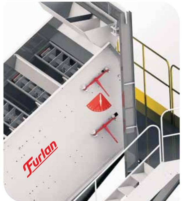
El equipamiento posee una señal de indicación de inclinación de trabajo. La inclinación es ajustable en función de las granulometrías y tipo de material que será procesado.
