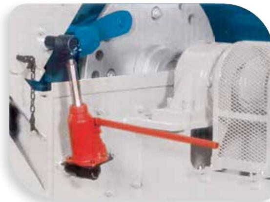
Sistema de apertura de la tapa, a través de gato hidráulico.
