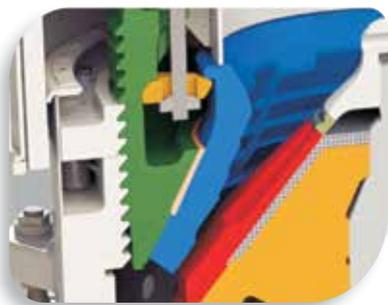
Detalle de la cámara de trituración (en corte).
