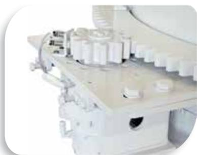
Sistema de ajuste de abertura (motor hidráulico).
