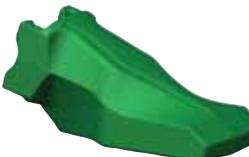
**ARH** – La punta ARH posee un diseño especial para operaciones sometidas a mucha abrasión en la escoria caliente. Dispone de una suela anti-desgaste muy grande, orejas más gruesas y una sección de caja más pesada para soportar las condiciones más adversas. Se puede usar en condiciones en las que se necesite la mayor cantidad de metal anti-desgaste.
