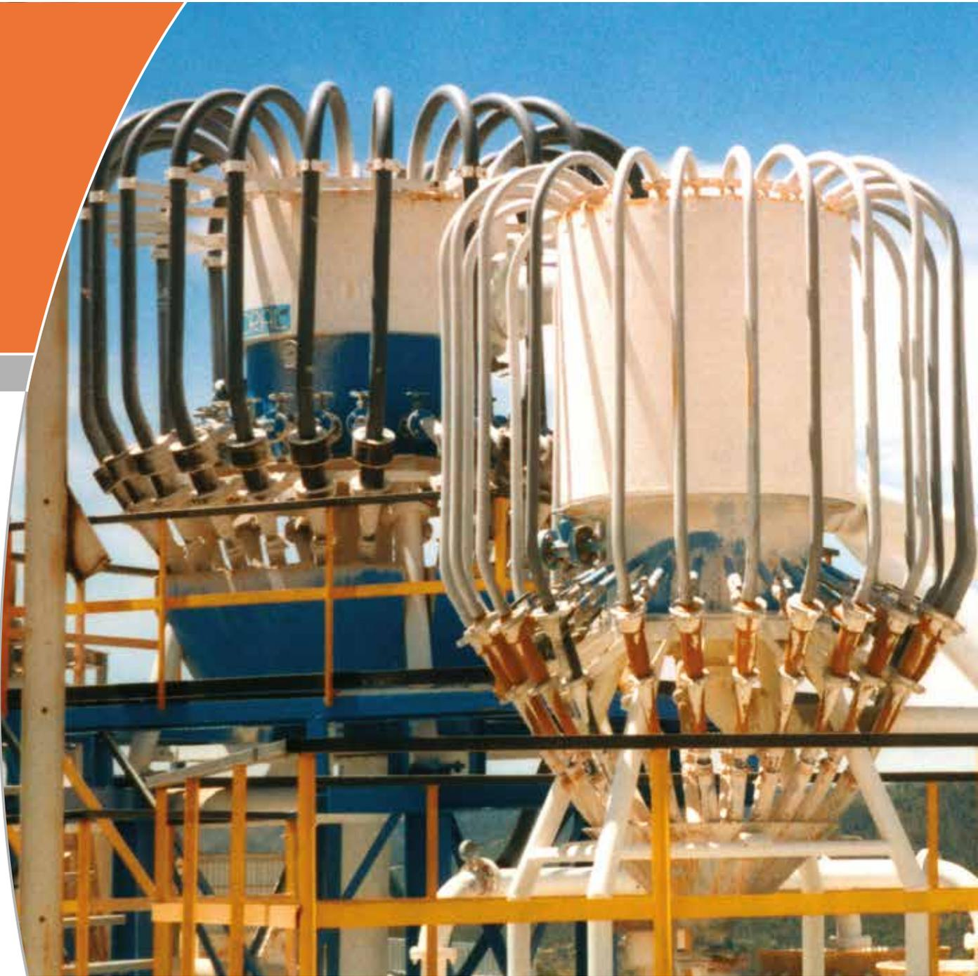
**ERAL** fabrica una extensa gama de modelos y tamaños de hidrociclones en geometría cónica y cilíndrica, lo que permite componer una diversidad de configuraciones y disponer de una amplia gama de ajustes por cada unidad, posibilitando adaptarse a cualquier problema concreto de clasificación y especificar el modelo de hidrociclón adecuado.
