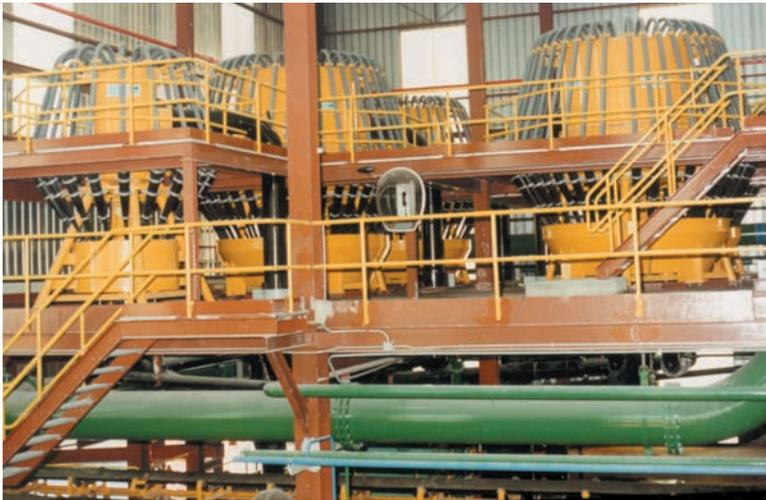
Deslamado y clasificación (30 $\mu$ m) de lignitos (Planta 500 t/h)
