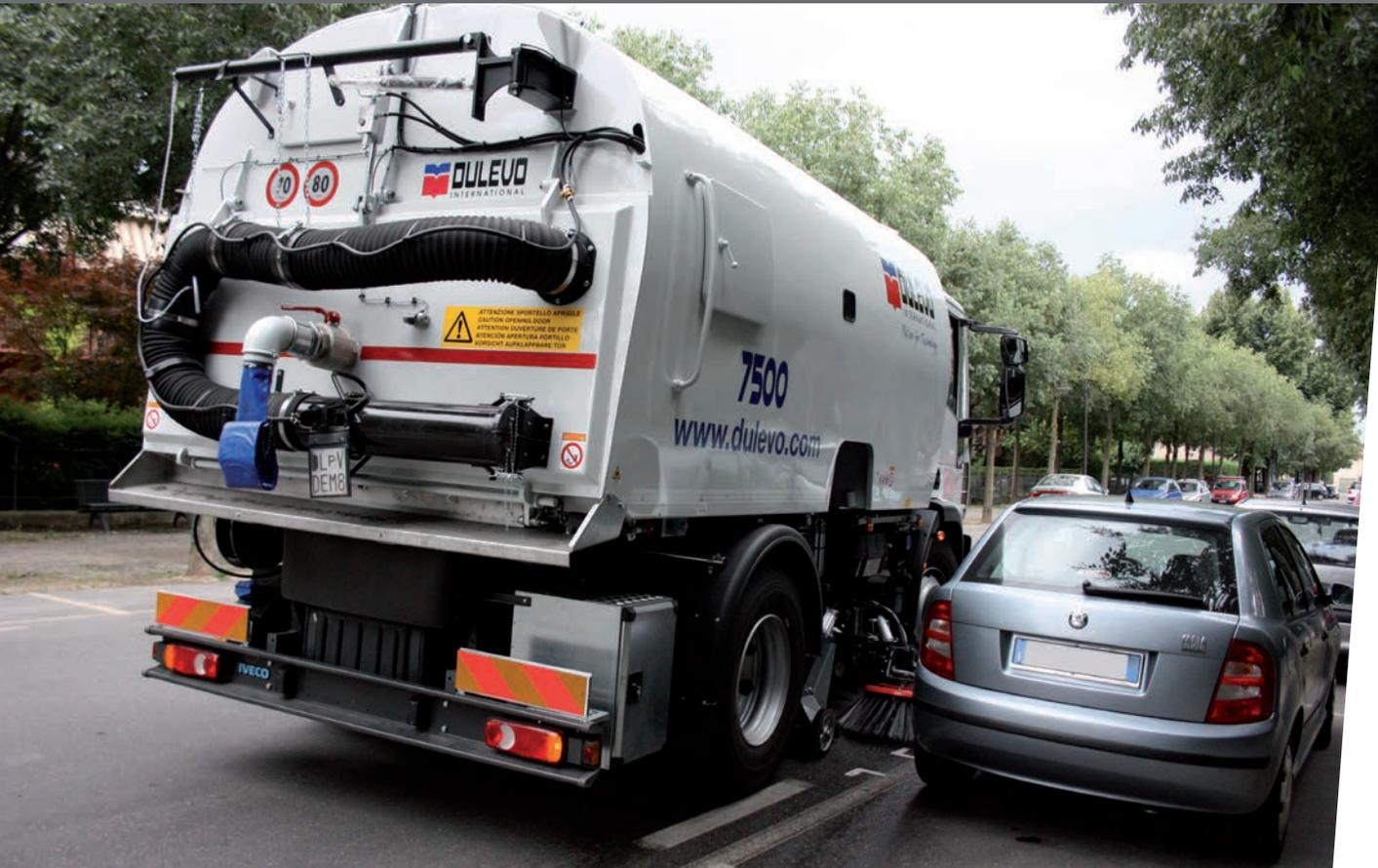
La recogida se realiza mediante aspiración con boca, cepillo giratorio de copa y cepillo de rodillo cilíndrico central. El ancho de la banda de barrido abarca, en la versión base, 2200 mm. La elevada capacidad de aspiración está garantizada por el motor auxiliar independiente y por la transmisión mecánica de la potencia al ventilador. Un sistema que permite obtener prestaciones constantes incluso en condiciones de uso extremas y que al mismo tiempo es extremadamente simple de usar y de mantener.
