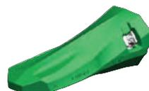
H – La punta H es para trabajo pesado en aplicaciones extremadamente abrasivas y está diseñada principalmente para las excavadoras. Cuenta con más metal de desgaste para alargar la vida útil de la punta. La costilla para uso extremo y el exclusivo sistema de rebaje en la parte inferior mantiene el autoafilado de la punta a medida que la misma se desgasta.
